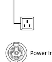
**注意：**连接电源时必须将地线（黄 / 绿双色线）安全接地，并符合电气安装所有相关标准。
