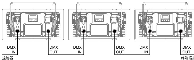
使用一条屏蔽双绞信号线从控制器的 DMX 输出口连接到第一台设备的 DMX 输入口，并从第一台设备的 DMX 输出口连接到第二台设备的 DMX 输入口，依此类推，直到将所有的灯具连接完毕，然后在每一连路的最后一个连接灯具输出 5 芯插孔上安装一个终端插头。（在 5 芯带针卡侬插头的 2、3 插针之间焊接一个 4/1W、120Ω 的电阻）。
