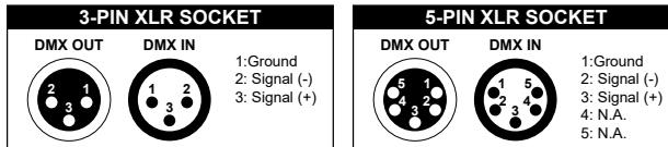
灯具设有标准的 DMX 输入和输出的 5 芯 XLR 插，请使用 DMX512 屏蔽双绞信号线。信号线一般连接距离为 150 米，长距离信号传输时，必须加入 DMX512 信号放大器。
