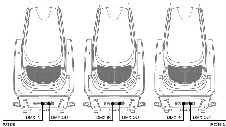
使用一条屏蔽双绞信号线从控制器的 DMX 输出口连接到第一台设备的 DMX 输入口，并从第一台设备的 DMX 输出口连接到第二台设备的 DMX 输入口，依此类推，直到将所有的灯具连接完毕，然后在每一个连接路的最后一个连接灯具输出 3 芯插孔上安装一个终端插头。（在 3 芯带针卡侬插头的 2、3 插针之间焊接一个 4/1W、120Ω 的电阻）。
