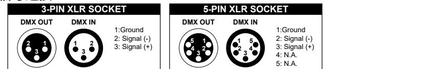
灯具设有标准的 DMX 输入和输出的 3 芯 XLR 插，请使用 DMX512 屏蔽双绞信号线。信号线一般连接距离为 150 米，长距离信号传输时，必须加入 DMX512 信号放大器。
