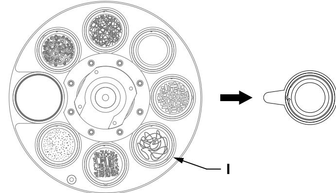
d. 用镊子或其他细小可夹持物把 **J** 处的卡簧取出（如果图案片涂有玻璃胶用以固定，请使用专业的清洗剂去除玻璃胶后再取出卡簧，以免损坏图案片）；
