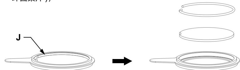
e. 装配图案片时，避免用手直接触摸图案片，并如 **K** 所示，将图案片有缺口的地方对准从动轮组件凹陷处（图案片镀膜面应朝向光源）；
