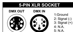
灯具设有标准的 DMX 输入和输出的 3 芯 XLR 插，请使用 DMX512 屏蔽
