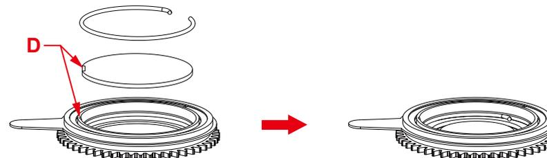
e. 将图案座插入主动轮组件，如 E 所示，图案座按照拆下来的顺序重新安装好；图案座定位点要对准主动轮的定位点；安装完毕后，将图案盘组件装回灯具上即可。
