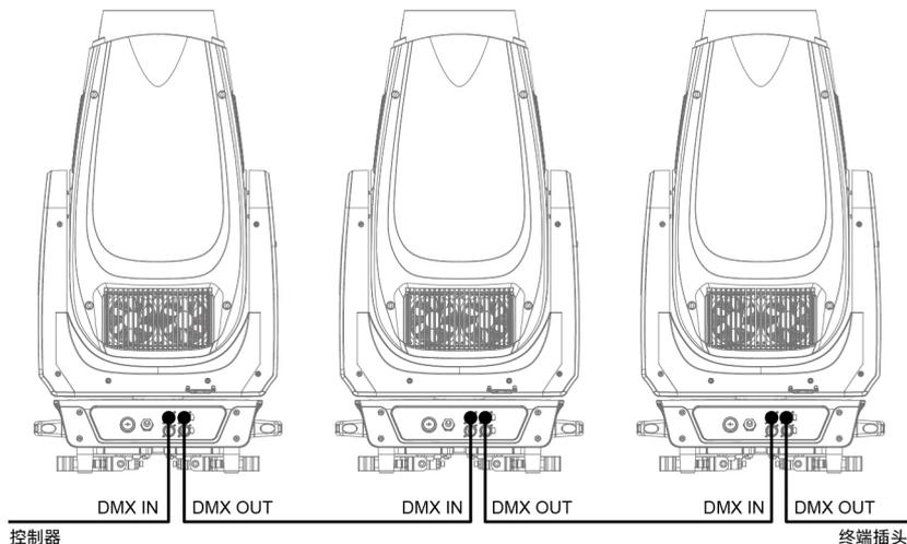
使用一条屏蔽双绞信号线从控制器的 DMX 输出口连接到第一台设备的 DMX 输入口，并从第一台设备的 DMX 输出口连接到第二台设备的 DMX 输入口，依此类推，直到将所有的灯具连接完毕，然后在每一连路的最后一个连接灯具输出 3 芯插孔上安装一个终端插头。（在 3 芯带针卡依插头的 2、3 插针之间焊接一个 4/1W、120Ω 的电阻）。
