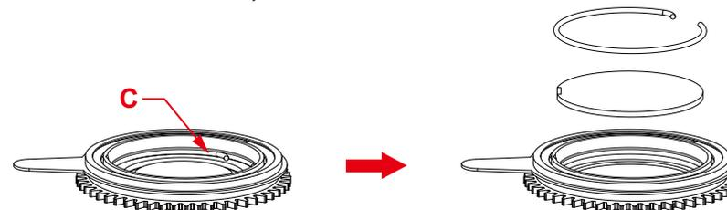
d. 装配图案片时，避免用手直接触摸图案片，并如 D 所示，将图案片有缺口的地方对准从动轮组件凹陷处 ( 图案片镀膜面应朝向光源 );
