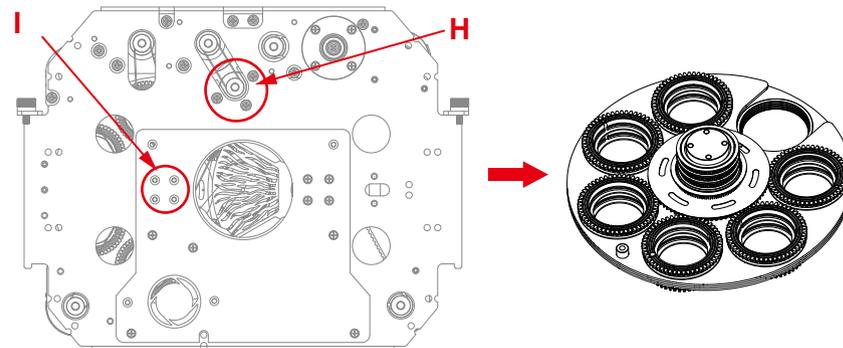
c. 如 J 所示，从图案盘二将图案座从动轮从边缘向上轻提后缓慢拔出，即可取出单个图案座；
