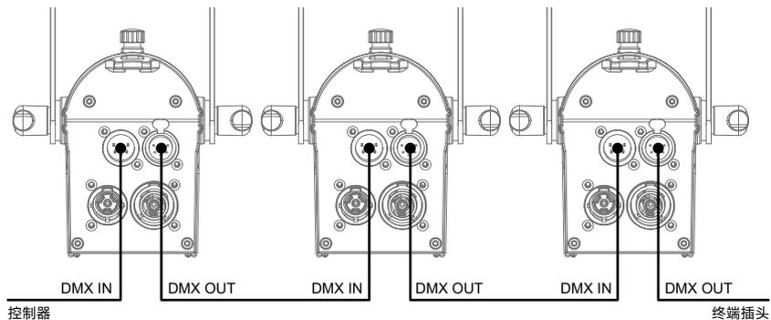
使用一条屏蔽双绞信号线从控制器的 DMX 输出口连接到第一台设备的 DMX 输入口，并从第一台设备的 DMX 输出口连接到第二台设备的 DMX 输入口，依此类推，直到将所有的灯具连接完毕，然后在每一连路的最后一个连接灯具输出 3 芯插孔上安装一个终端插头。（在 3 芯带针卡侬插头的 2、3 插针之间焊接一个 4/1W、120Ω 的电阻）。
