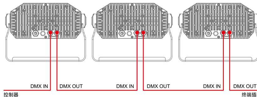
使用一条屏蔽双绞信号线从控制器的 DMX 输出口连接到第一台设备的 DMX 输入口，并从第一台设备的 DMX 输出口连接到第二台设备的 DMX 输入口，依此类推，直到将所有的灯具连接完毕，然后在每一连路的最后一个连接灯具输出 3 芯插孔上安装一个终端插头。（在 3 芯带针卡侬插头的 2、3 插针之间焊接一个 4/1W、120Ω 的电阻）。
