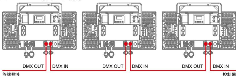
使用一条屏蔽双绞信号线从控制器的 DMX 输出口连接到第一台设备的 DMX 输入口，并从第一台设备的 DMX 输出口连接到第二台设备的 DMX 输入口，依此类推，直到将所有的灯具连接完毕，然后在每一连路的最后一个连接灯具输出 3 芯插孔上安装一个终端插头。（在 3 芯带针卡侬插头的 2、3 插针之间焊接一个 4/1W、120Ω 的电阻）。
